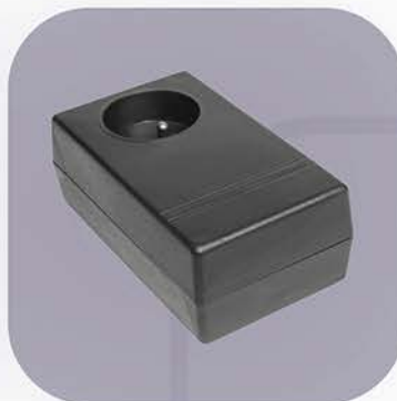
Z31 MATERIAŁ: ABS SZER. / DŁ. / WYS. [mm]: 70 / 120 / 44 DWUCZĘŚCIOWA DOSTĘPNY KOLOR: ■
