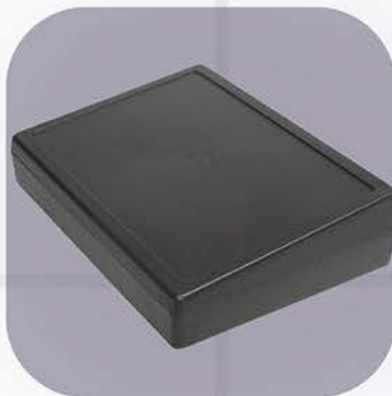
Z33A MATERIAŁ: ABS SZER. / DŁ. / WYS. [mm]: 140 / 190 / 46 DO ZASILACZY DOSTĘPNY KOLOR: ■
