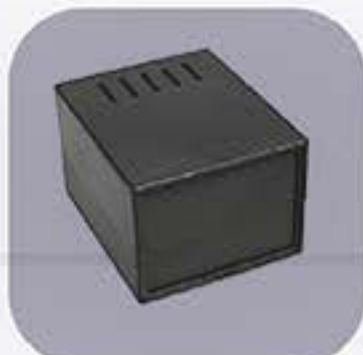
Z3AW MATERIALE: PS/ABS A / L / l (mm): 68 / 90 / 110 CON PANNELLI LATERALI COLORI DISPONIBILI: ■
