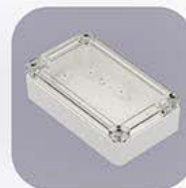
ZP125.75.37S MATERIALE: ABS/ PC CON GUARNIZIONE FUSA A / L / l (mm) 37 / 75 / 125 COLORI DISPONIBILI: ■ ■
